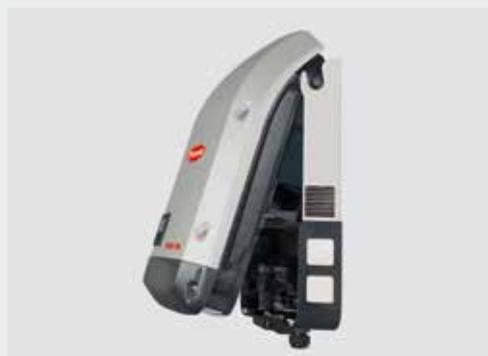
manutenzione estremamente semplice e agevole. L'inverter viene semplicemente posizionato sulla staffa a parete e successivamente fissato. Non è necessario rimuovere l'intero inverter durante la manutenzione, ma solo le fonti di energia. Tutti i collegamenti, le impostazioni e le configurazioni restano così invariati.
