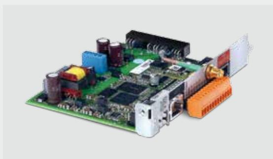
*/ Fronius Datamanager invia i valori dell'impianto al portale online Fronius Solar.web direttamente via WLAN*
